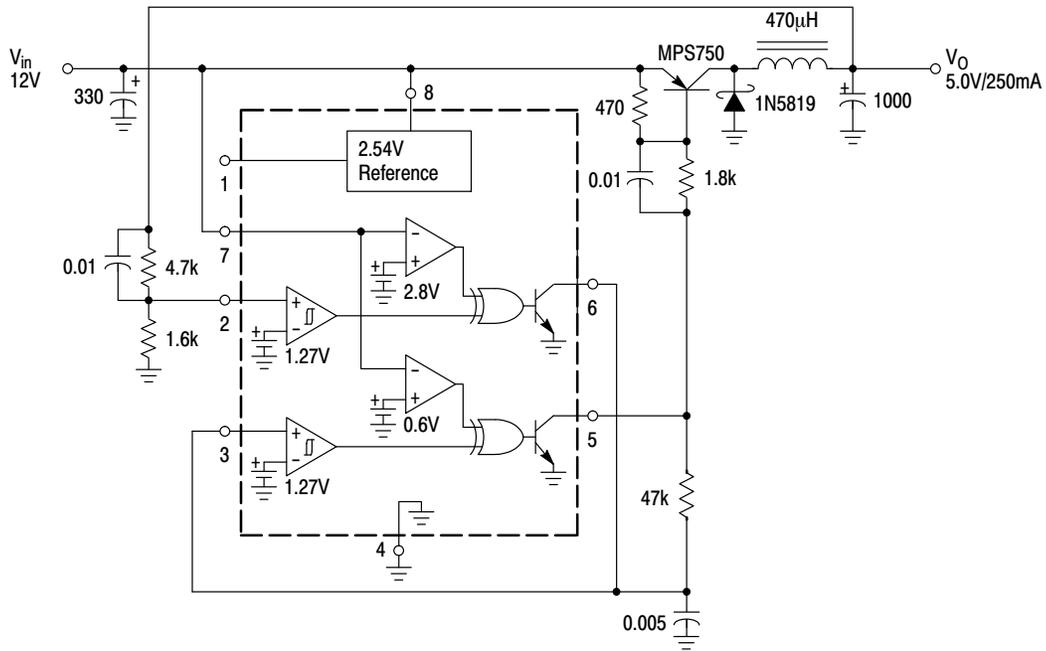
**Figure 27. Step-Down Converter**
